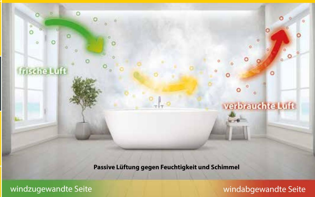
Passive Lüftung gegen Feuchtigkeit und Schimmel
