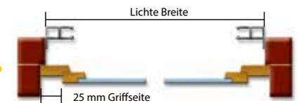
Die Fensterrahmenbreite muss auf der Griff-Innenseite **mind. 25 mm** betragen. Die Bohrung für die Gurtdurchführung erfolgt durch den Fensterrahmen unterhalb vom Sturz.
