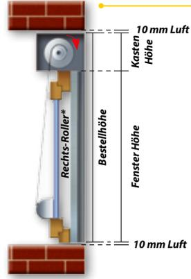
**Der Aufsatzrollladen wird auf das Fensterprofil montiert**
