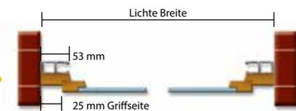
Die Fensterrahmenbreite muss für die Führungsschiene auf der Außenseite mind. 53 mm und zur Montage des Gurtwicklers auf der Griff-Innenseite mind. 25 mm betragen. Werden diese bauseitigen Vorgaben nicht erfüllt, kann die-
